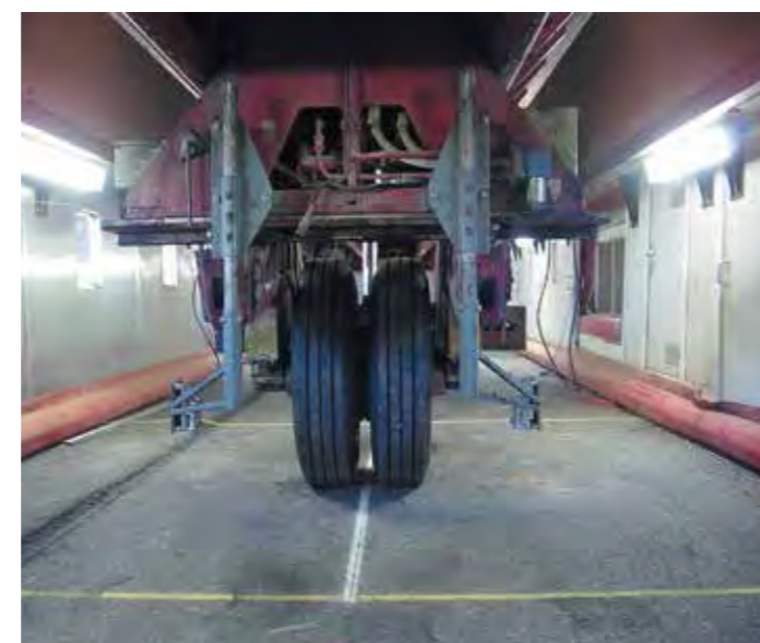
坦萨多年来进行了大量的实验室研究和足尺试验, 以评估坦萨格栅在柔性路面中的加固作用
