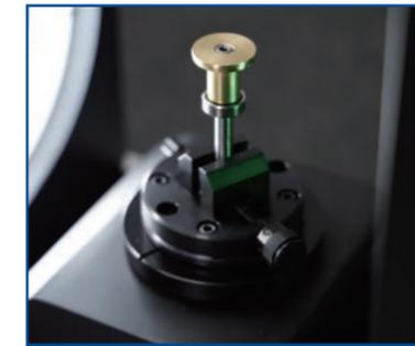
表面照明、自动对焦和旋转控制的结合允许在单次拍摄中测量不同平面上的表面特征。
