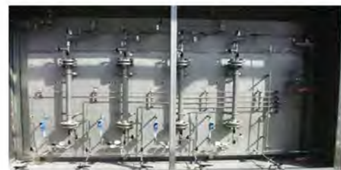
脱汞剂在泰国国家石油公司 (PTT) 天然气管道脱汞测线试验
