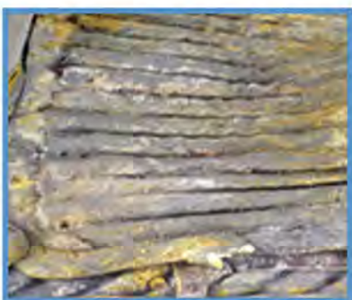
AetherAir除臭垫有黄色晶体析出
