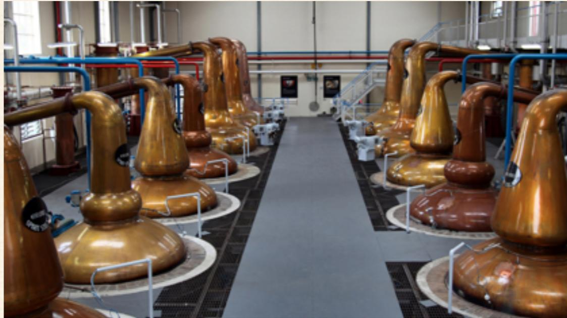
采用以酿造醇香苏格兰威士忌而闻名的传统铜质壶式蒸馏器处理。
