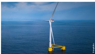
奥雅纳为爱尔兰西海岸1.35GW 漂浮式海上风场西部之星提供完整的 **Pre-FEED** 研究，全面分析了电力送出至电网的可行性，确定了首选设计方案，包括登陆点和电缆路线选择，并进一步开发设计以降低风险，估算初始成本等。
