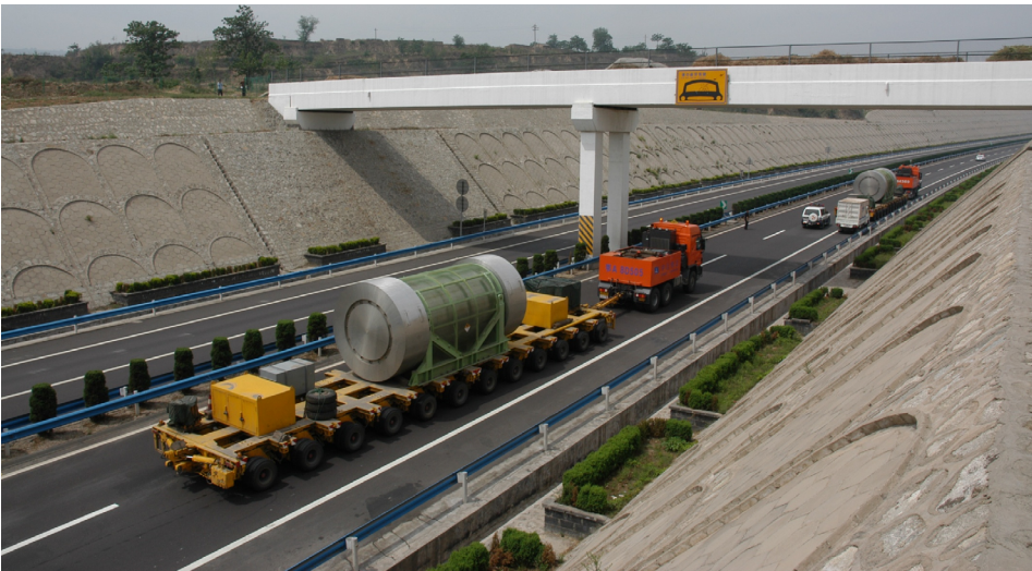
图 -6 核电站乏燃料公路运输
