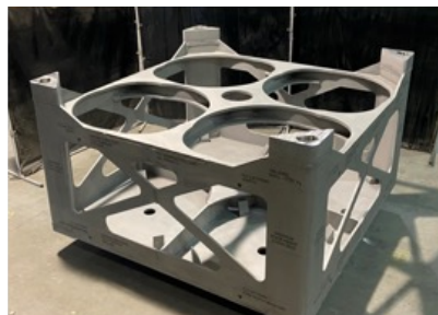
Magnox 临时储存搁架
