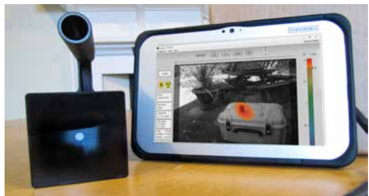
带SmartSpot™软件的迷你伽马相机
