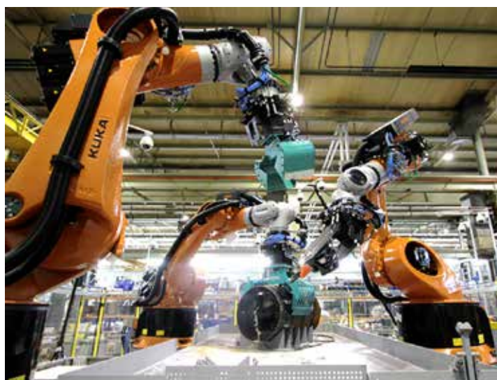
机器人废物分类。对废物进行拣拾、放置、减容和分类。
