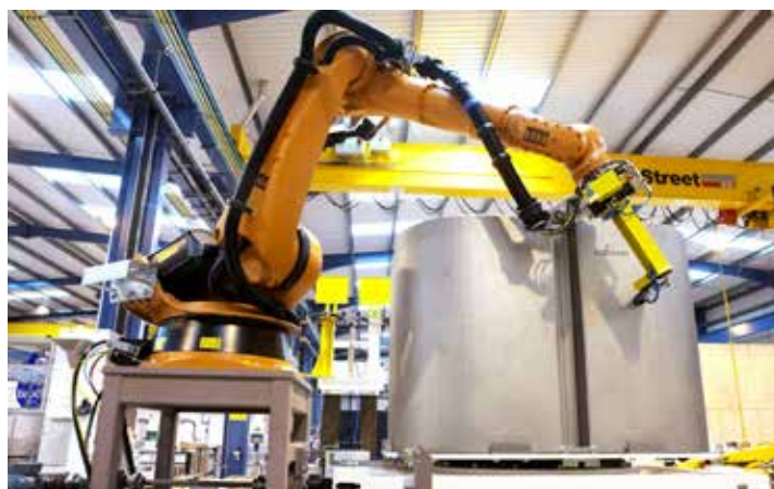
机器人清洗。机器人完成隔间的清洗,检查清洗结果,是否满足清洁度标准。
